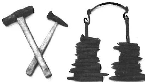
Abb. 7: Schlägel und Eisen: Arbeitsgerät und in gekreuzter Form Symbol des Bergbaues, Originalwerkzeuge, 19. Jh., Freiburger Revier, Sammlung für Bergbaukunde, Bergakademie Freiberg.
